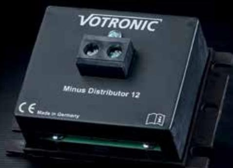
Kompakter Minus-Verteiler für mit 12 einzelne Stromkreisen zur fachgerechten Verteilung von kleinen bis mittleren Verbrauchern auf der Batterie-Minusseite. Zwei große Sammelklemmen für Kabelquerschnitte bis  $16 \text{ mm}^2$  und einer Strombelastbarkeit von max. 50 A dienen der Stromführung und Durchgangsverteiung.
