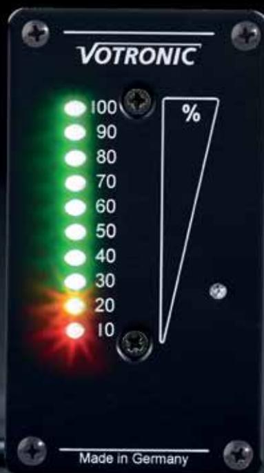
Das LED Tank-Display HE dient zur genauen Anzeige des Lösch tanks im Fahrzeug. Es ist als Panelversion für den Einbau in Anzeigetafeln vorgesehen und mit zwei genormten Messsignalen (0...10 V bzw. 4...20 mA) erhältlich. Damit ist das Gerät nicht nur für den VOTRONIC Tank-Sensor FW verwendbar, sondern kann auch an Messwertgebern anderer Hersteller mit gleichen Normsignalen betrieben werden.
