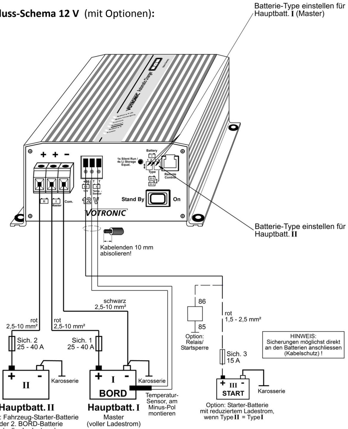
Hinweis: Das Gerät arbeitet aus Sicherheitsgründen bei LiFePO<sub>4</sub>-Batterien **nur** mit angeschlossenem Temperatur-Sensor (im Lieferumfang)! Sensor am Minus-Pol der Batterie anschrauben.
