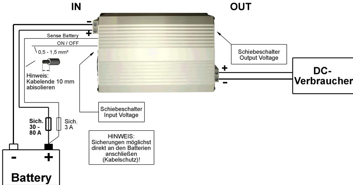
Zuerst den Gleichspannungs-Wandler anschließen, dann die Batterie.
