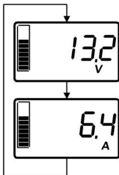
**Spannung:** Es wird die Spannung (Volt „V“) der Bord-Batterie angezeigt.
