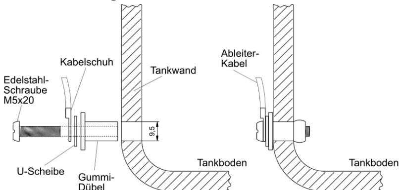
Der Ableiter stellt den Kontakt zum Wasser her. Daher möglichst **weit unten am Kunststoff-Tank** die  $\varnothing$  9,5 mm Bohrung für den **Ableiter** setzen. Bohrung entgraten!
