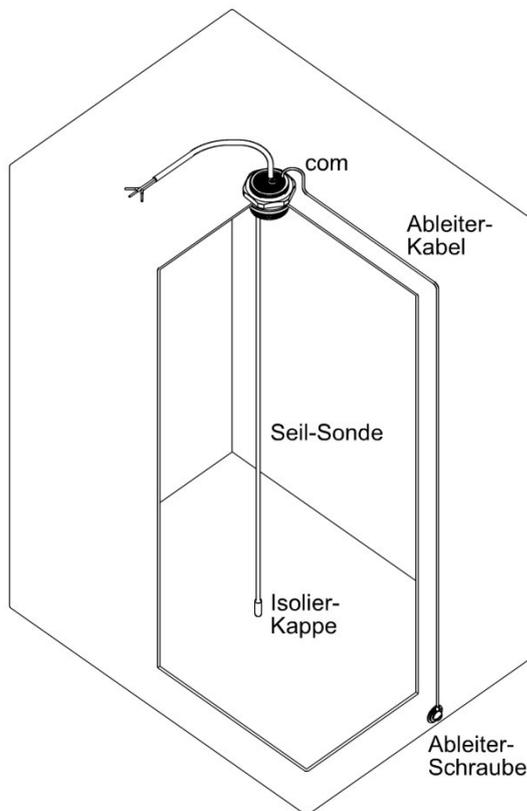
Die **Tankelektrode K-FL** wird zur Füllstandsfernmessung direkt am Tank montiert und ist geeignet für:
