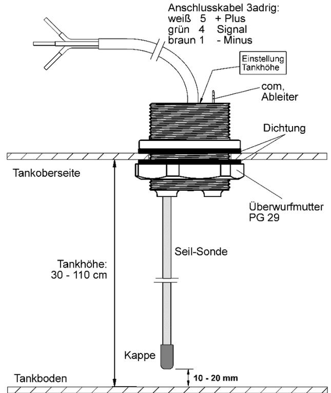
Danach die Seil-Sonde gerade ziehen, auf Länge abschneiden und die Isolierkappe auf das **Sonden-Ende** schieben.
