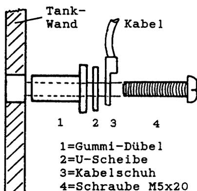
**Abb. 4: Ableiter bei Metalltanks**
