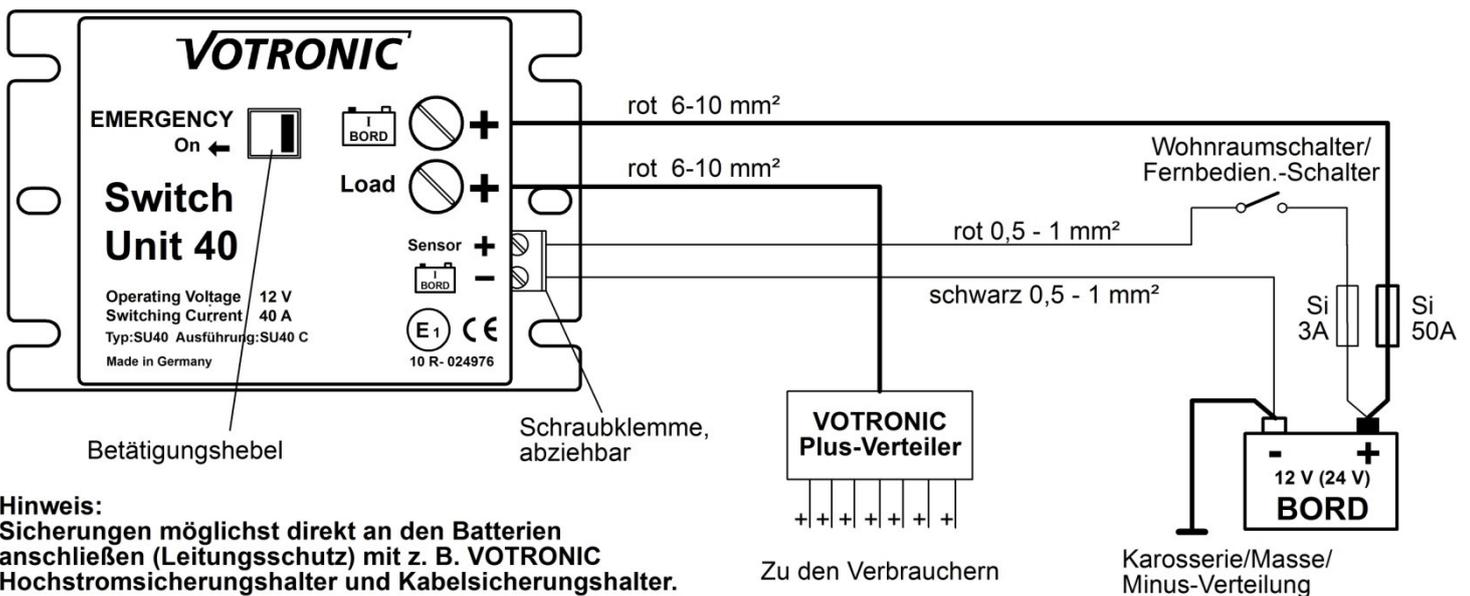
Diese Beschaltung realisiert durch einen im Wohnraum installierten Schalter eine effektvolle Fernbedienung. Der Schalter wird nur sehr gering belastet (0,002 A), so dass auch eine Miniaturausführung ausreichend ist.
