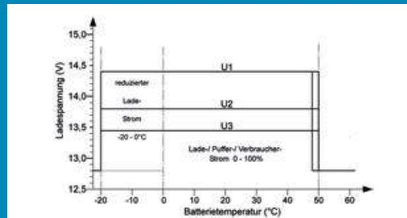
Beispiel: Ladespannung LiFePO4-Batterien
