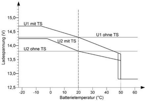
TS = bei Verwendung eines Temperatur-Sensors
