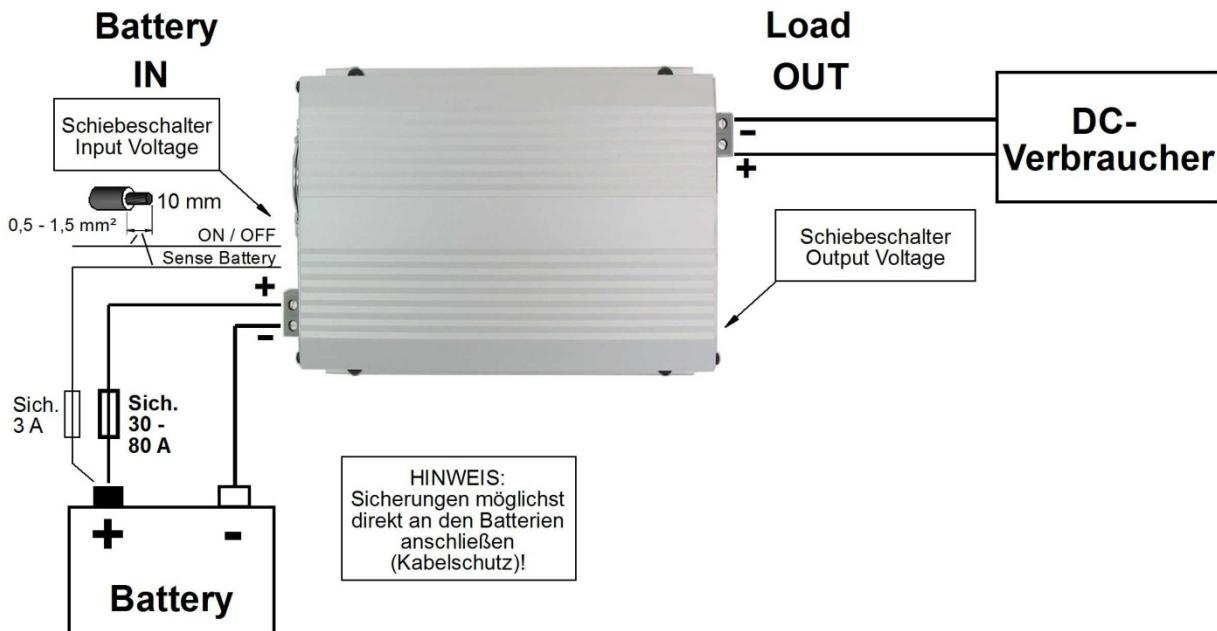
Zuerst den Gleichspannungs-Wandler anschliessen, dann die Batterie.
